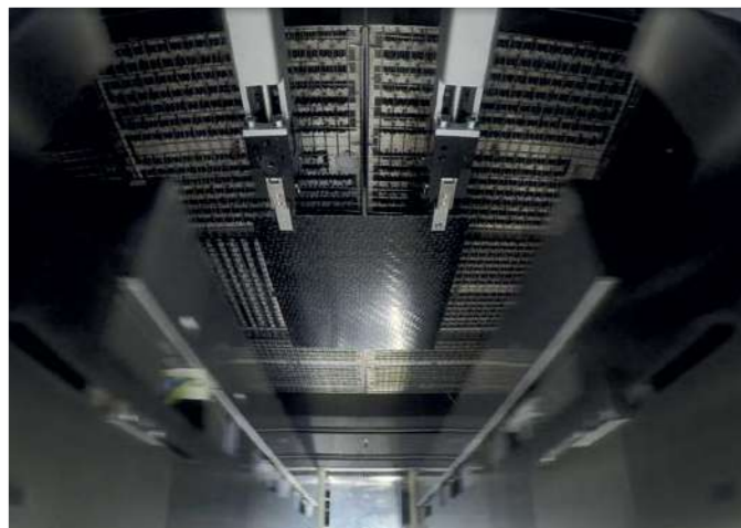
CT LT - Cabezal de medición con dispositivo de purga de aire laminar en una termoformadora
