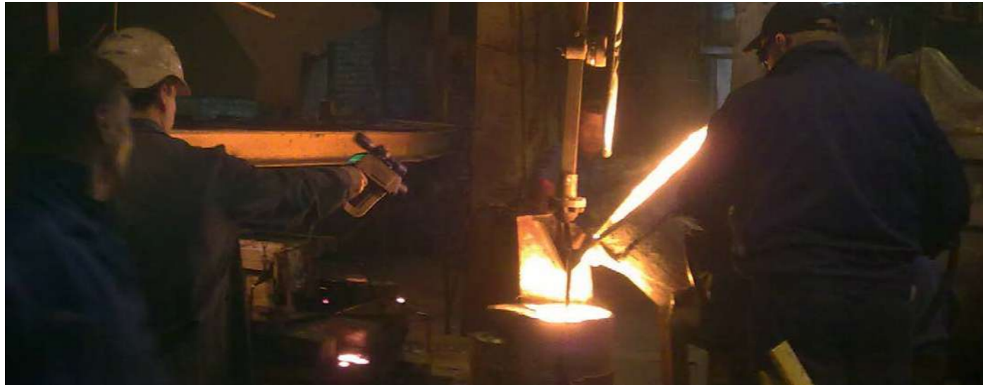
Medición detallada de la temperatura por infrarrojos de una masa fundida en la planta de fundición con el P20 05M.
