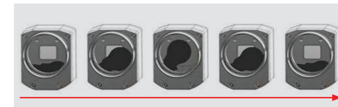
Para la referenciación offset, se desplaza brevemente una referencia de temperatura en el campo de visión del conjunto de sensores infrarrojos.
